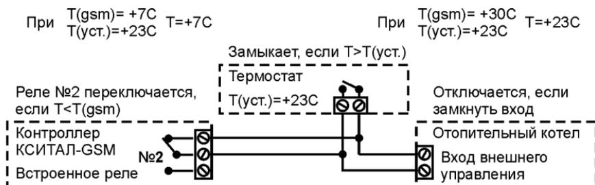
При таком подключении KSITAJ-GSM поддерживает дистанционно задаваемое значение температуры (см. раздел "Температура включения реле нагревателя") в помещении ниже установленной на автономном термостате.
