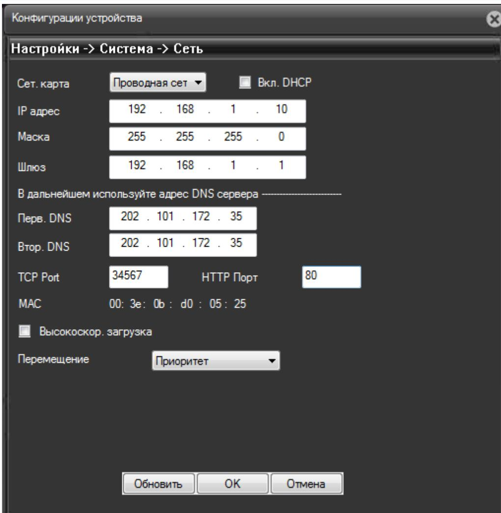
Можно задать получение адреса камерой от DHCP (при этом необходимо, чтобы сервер DHCP был в сети) при установке параметра **DHCP** либо вручную.
