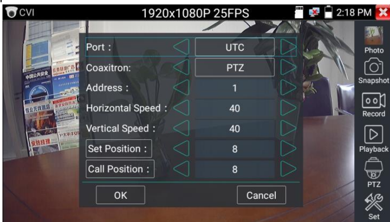
Рис. 78 Настройки для управления PTZ CVI видеокамерой по коаксиальному кабелю
