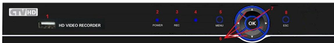
На передней панели регистратора находятся следующие индикаторы и органы управления: 1) USB-порт (запараллелен с нижним USB-портом задней панели); 2) Индикатор включения; 3) Индикатор включения записи; 4) Индикатор активности HDD; 5) Кнопка вызова экранного меню; 6) Кнопки выбора режима просмотра камер. Также служат для навигации в меню; 7) Кнопка подтверждения выбора; 8) Кнопка выхода из меню. При работе с меню этой же кнопкой осуществляется возврат в предыдущий раздел меню.
